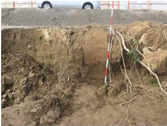
写真-3 流出跡の地盤表層部 (堤防近傍;土質は細砂)
